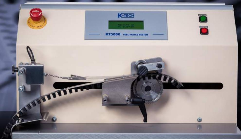
Die Abzugskraft ist ein kritischer Parameter für jeden Anwender von Tape & Reel. Ist die Klebekraft der Deckfolie zu gering, besteht die Gefahr, dass sich die Deckfolie löst und die Bauteile aus dem Gurt herausfallen. Ist diese Kraft jedoch zu groß, gibt es Probleme beim Abziehen der Deckfolie, was wiederum zu Störungen an den Bestückautomaten führt.
